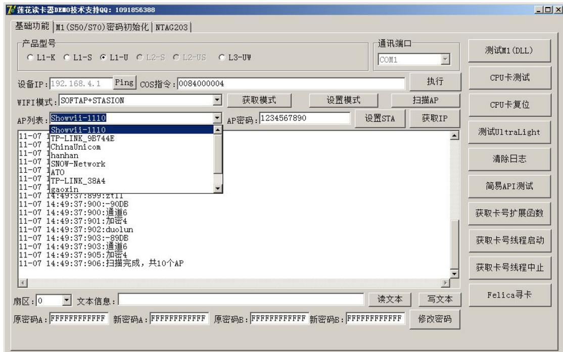
选中需要连接的 AP, 输入 AP 密码, 点击设置 STA, 读卡器随后会自动连接选中的路由, 路由需要打开 DHCP 为读卡器提供 IP 地址, 如果
